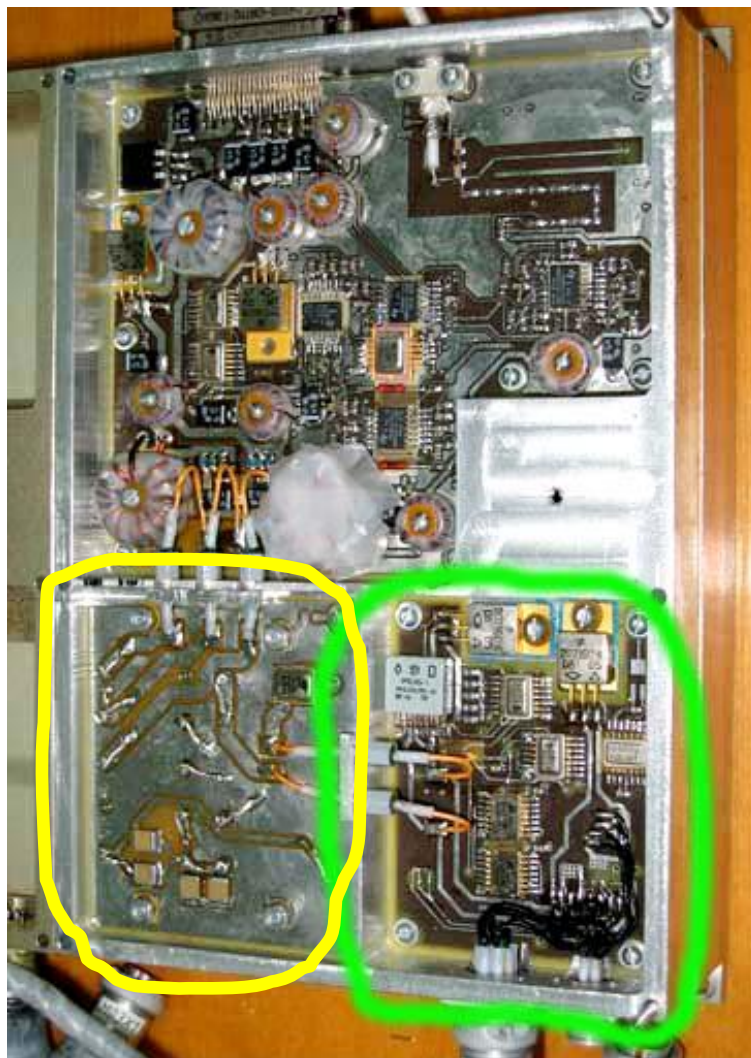
Рис. 8.1. Блок электроники, зеленой линией обведен узел 01, желтой – узел 02 и оставшаяся часть принадлежит узлу 03.
